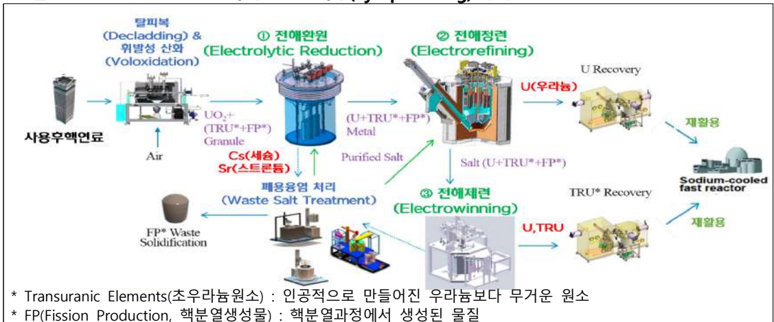
〈그림 6〉 파이로프로세싱(Pyroprocessing) 공정도
