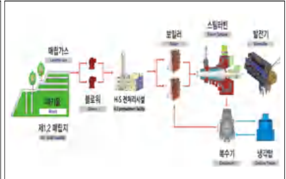
<그림 8> 매립시설 에너지 생산 공정 예시
